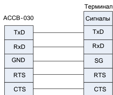
Рис.10. Схема подключения ACCB-030 к терминалу аппаратного управления потоком.
