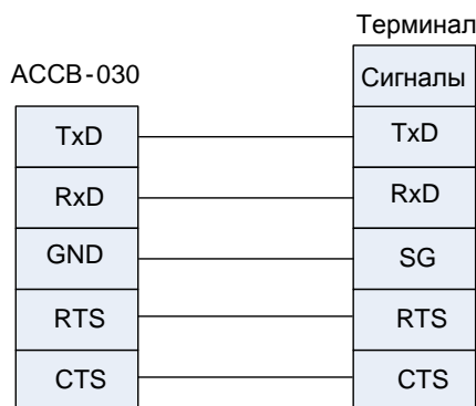
Рис.10. Схема подключения АССВ-030 к терминалу аппаратного управления потоком.
