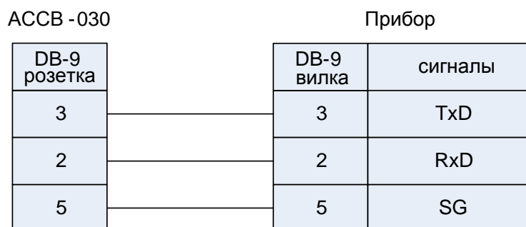
Рис.3. Подключение прибора по интерфейсу RS-232.
