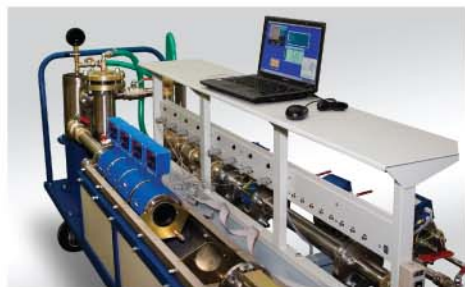
Установка калировки электромагнитных расходомеров
