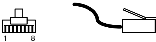
а) вид и нумерация контактов разъема RJ45
