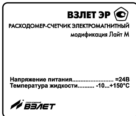
Рис.5. Вид маркировки на лицевой панели расходомера
