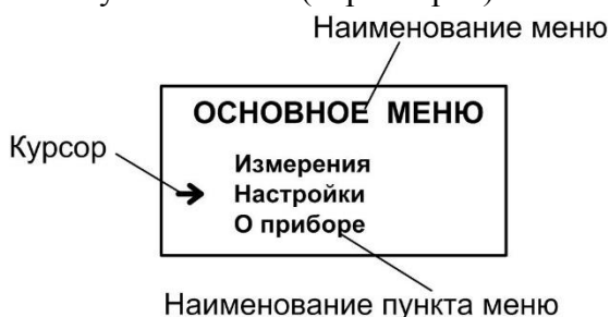
Рис.5 - Вид основного меню расходомера.
