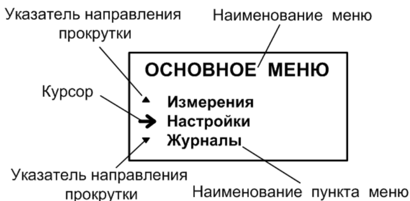
Рис.3 - Вид основного меню уровнемера.
