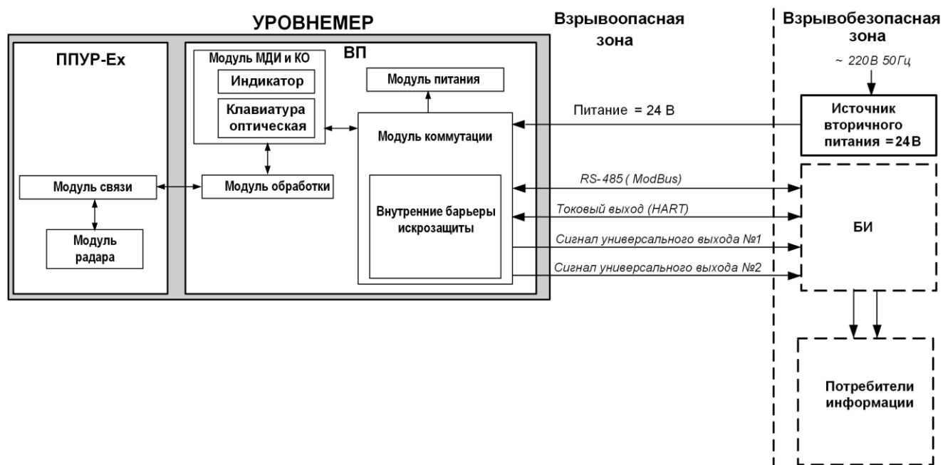
Рис.2 - Структурная схема уровнемера.
