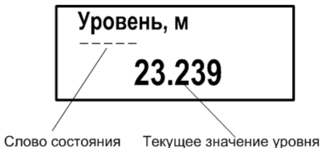
Рис.4 - Вид окна укрупненной индикации измеряемого параметра.
