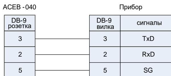
**Рис.3. Подключение прибора по интерфейсу RS-232.**
