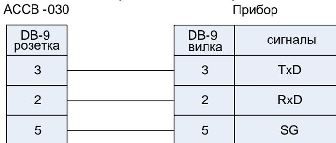
Рис.3. Подключение прибора по интерфейсу RS-232.
