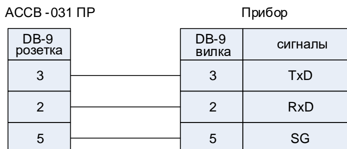
Рис.12. Подключение прибора по интерфейсу RS-232.
