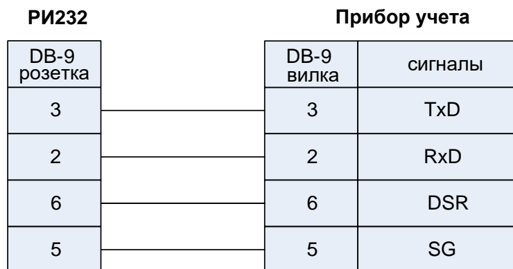
Рис.5. Подключение приборов СПТ943, СПТ943.1.
