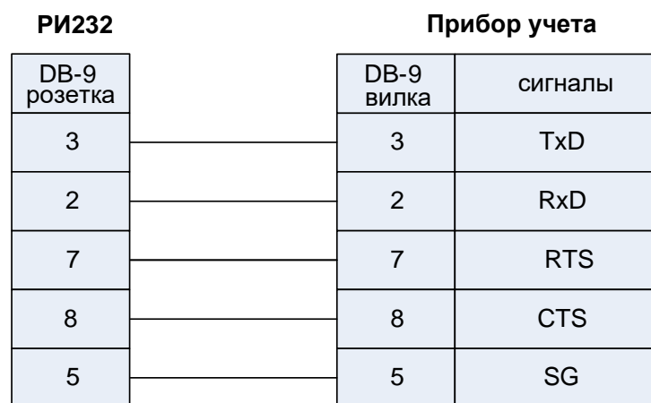
Рис. 4. Подключение приборов СПТ961, СПГ761.
