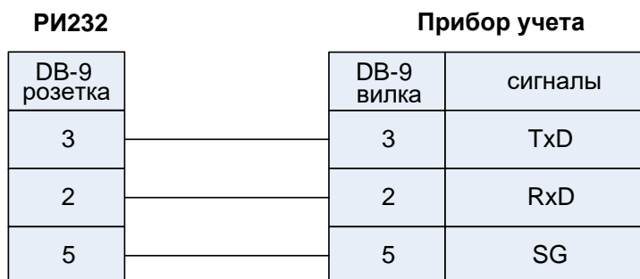
Рис.3. Подключение прибора учета фирмы «Взлет».
