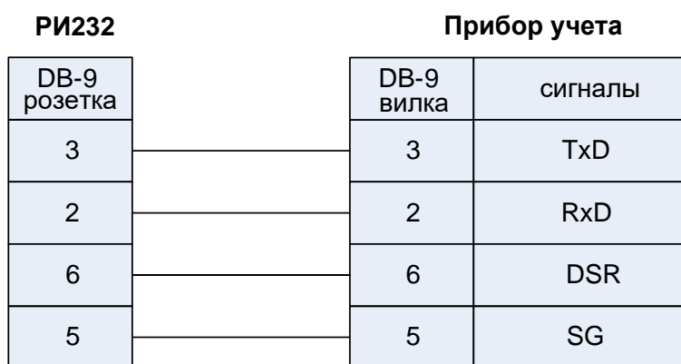
Рис.8. Подключение ВКТ-7 к адаптеру РИ232.
