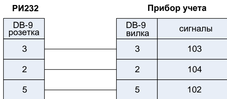
Рис.6. Подключение АПС-45 к адаптеру РИ232.
