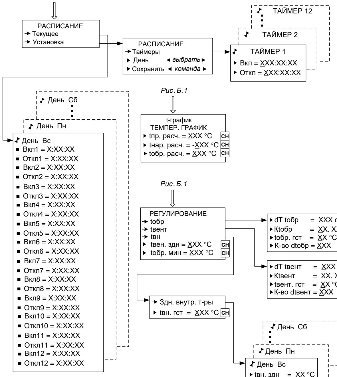
Рис.Б.2. Вид меню «РАСПИСАНИЕ», «t-график» и «РЕГУЛИРОВАНИЕ».
