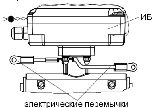
Рис.9. Электрические перемычки на ИБ расходомера.
