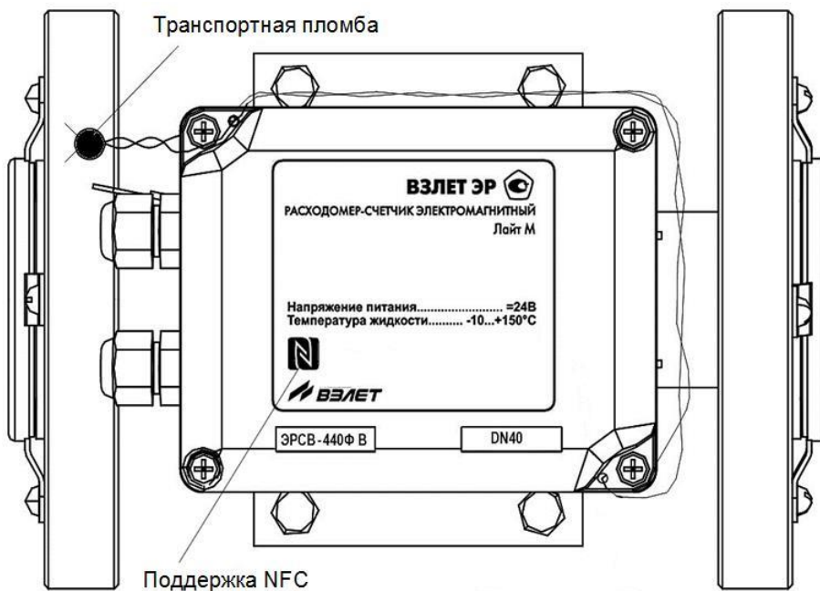
а) корпус измерительного блока выполнен из пластмассы
