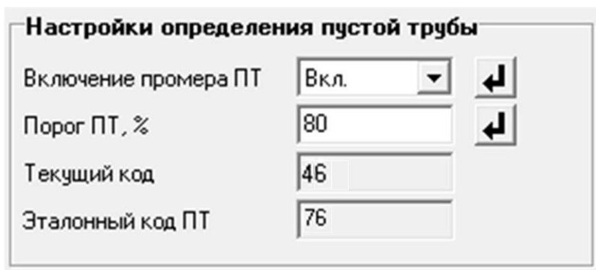
Рис.7. Вид группы «Настройки определения пустой трубы».
