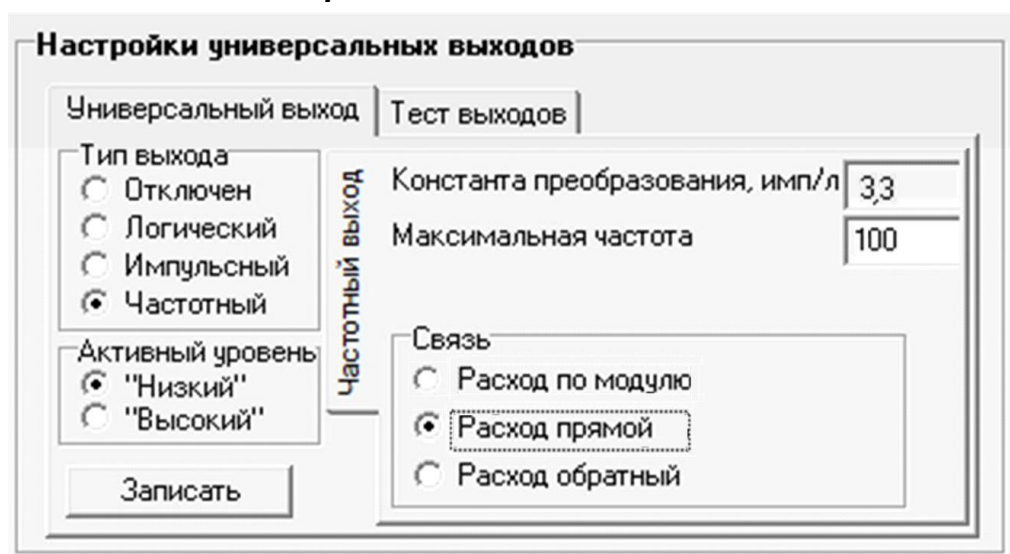
Рис.10. Вид группы «Настройки универсальных выходов» - «Частотный выход».
