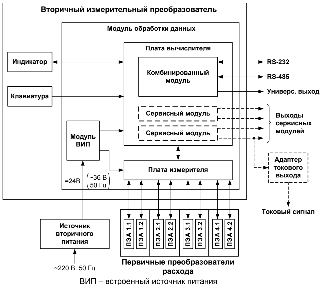
Рис. 4. Структурная схема четырехканального расходомера.
