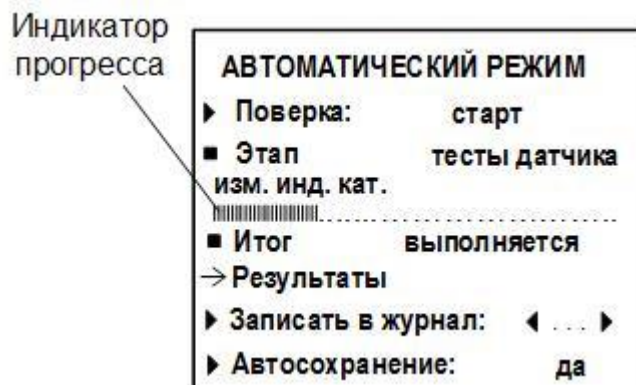
Рис.12. Отображение хода поверки на индикаторе КПИ.
