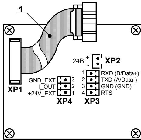
1 – шлейф связи с модулем обработки;
