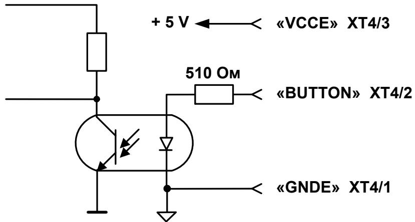
Рис. Б.3. Схема входного каскада.
