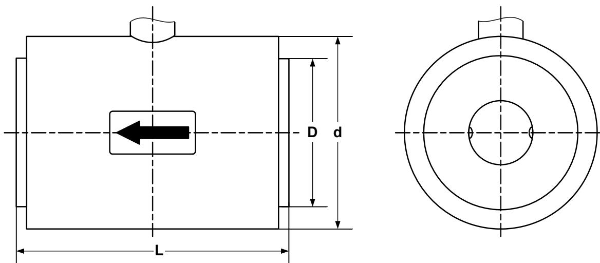
**Рис. А.3. Вид ППР расходомеров исполнений ПРОФИ-xxxx, -xxxxA, -xxxxI без защитных колец.**
