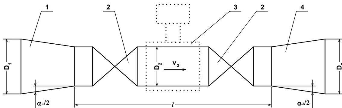
1 – конфузор; 2 – полнопроходная шаровая задвижка; 3 – ППР; 4 – диффузор.
