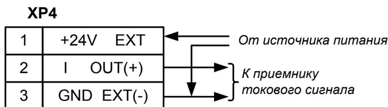
**Рис. Б.2. Разъем XP4 токового выхода расходомера на плате модуля индикации.**
