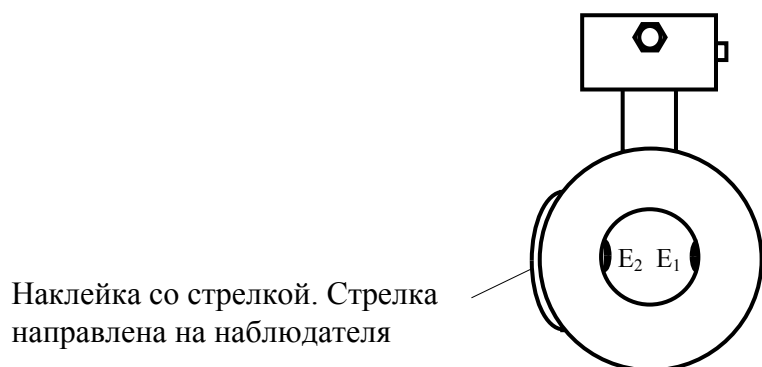
Рис. 1. Схема расположения сенсоров ЭМР на ПР.
