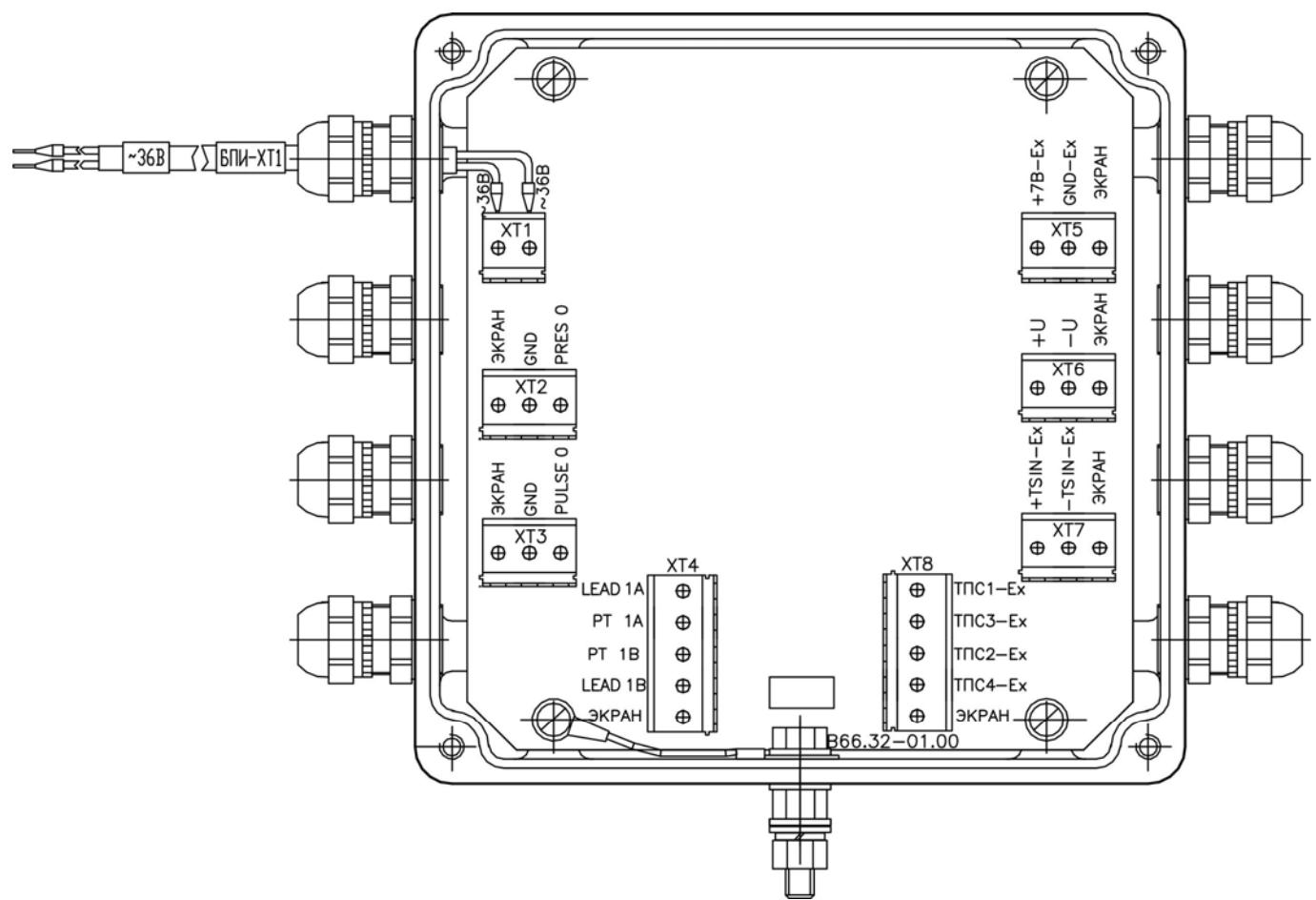
Рис. В.1. Схема размещения клеммных колодок БПИ 700.
