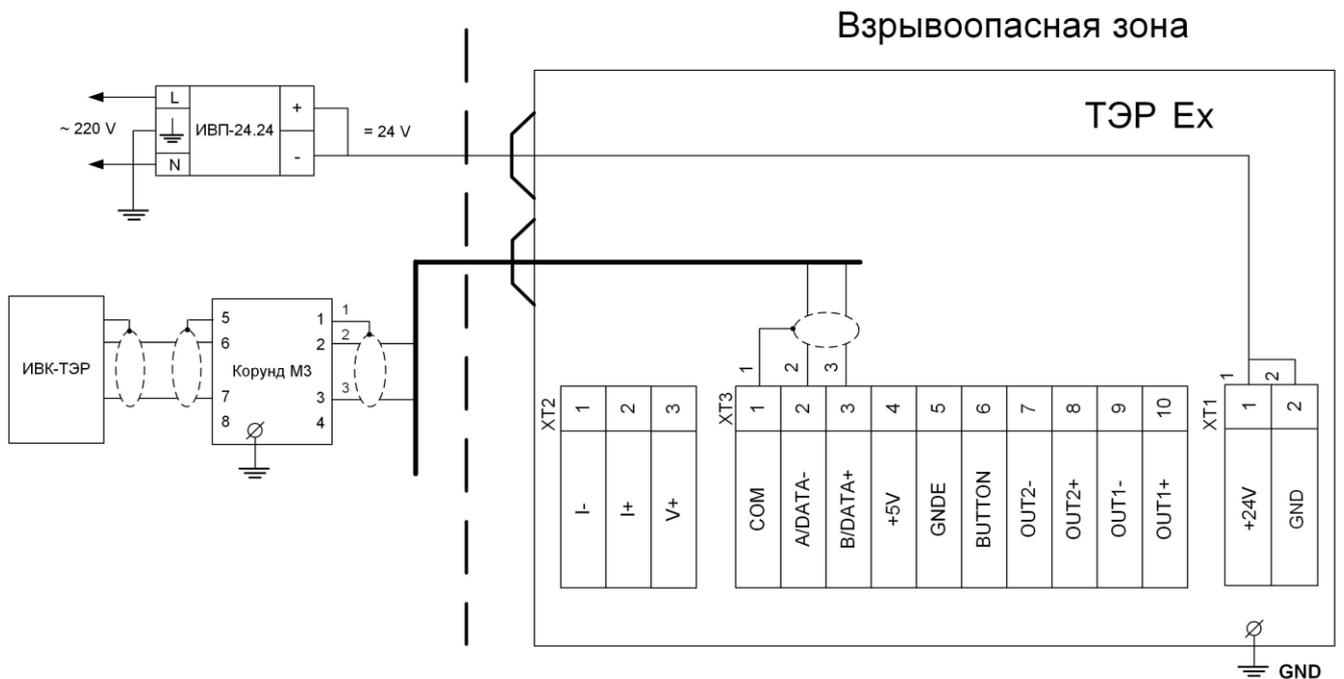
Примечание - При использовании кабеля КВВЭнг  $1 \times 2 \times 0,75 \text{ мм}^2$  – одна витая пара в экране (выводы экрана изолируются от «земли»).
