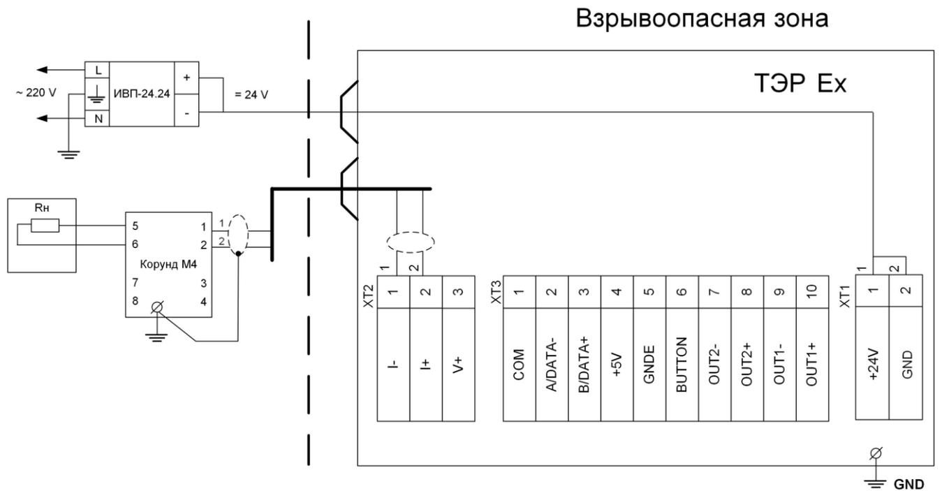
Примечание - При использовании кабеля КВВЭнг  $1 \times 2 \times 0,75 \text{ мм}^2$  – одна витая пара в экране.
