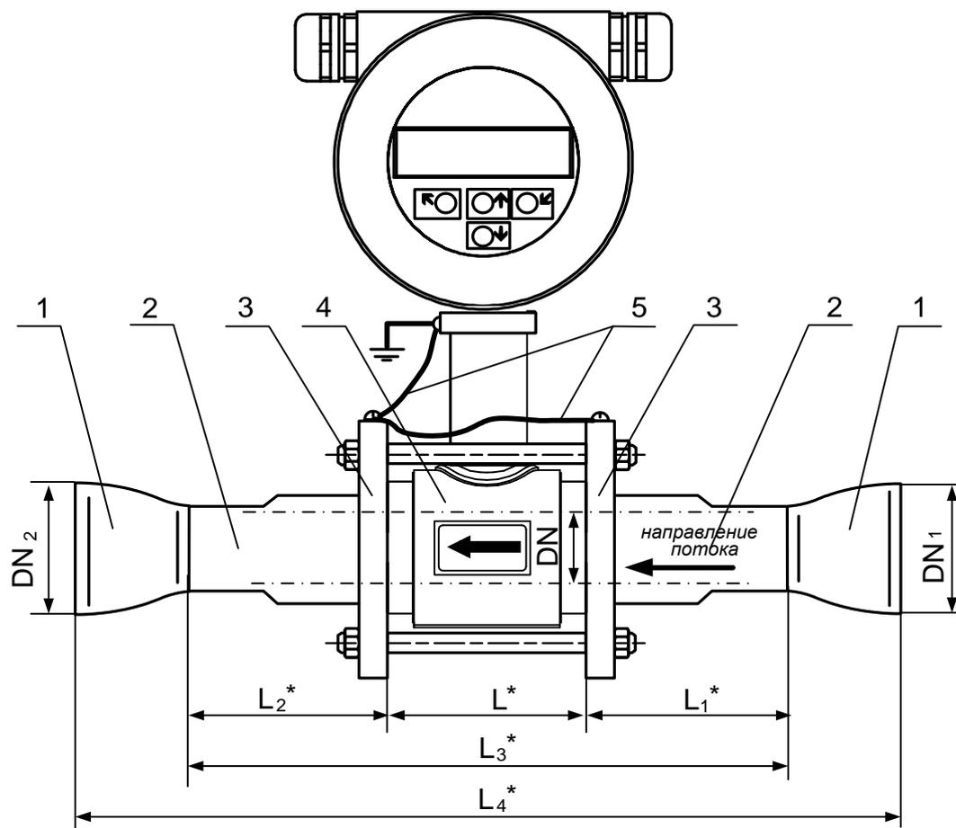
1 – конусный переход; 2 – прямолинейный отрезок трубы; 3 – прилегающий фланец;
