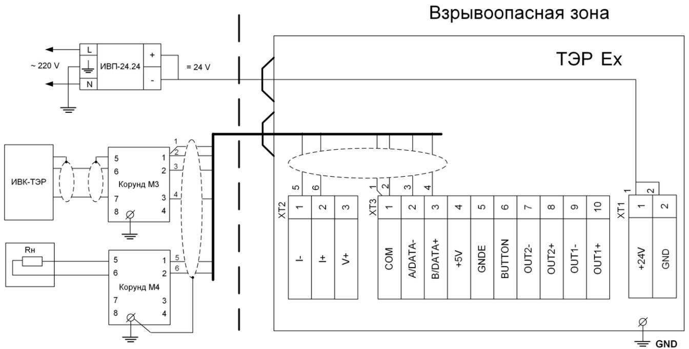
Примечание - При использовании кабеля с тремя витыми парами ОВ-ВЛ-РААР-СУ  $3 \times 2 \times 0,5 \text{ мм}^2$  в общем экране.
