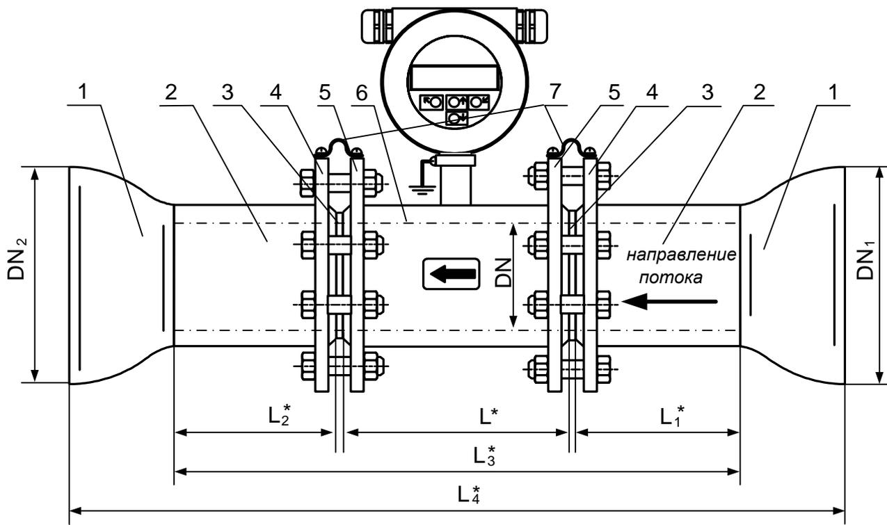
*1 – концентрический переход; 2 – прямолинейный отрезок трубы; 3 – паронитовая прокладка; 4 – прилегающий фланец трубопровода; 5 – фланец ППР; 6 – ТЭР (габаритный имитатор ППР); 7 – электрические переключатели для соединения фланцев ТЭР и трубопровода.*
