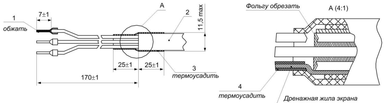
1 – наконечник Order N DN00708 DINKLE; 2 – кабель КВВЭнг  $1 \times 2 \times 0,75 \text{ мм}^2$ ;
