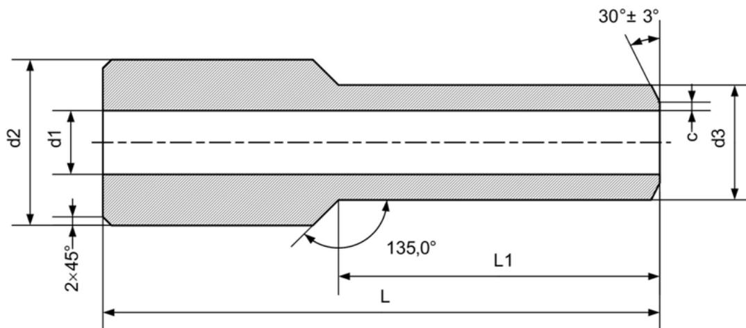
Рис.Б.3 - Вид переходных патрубков
