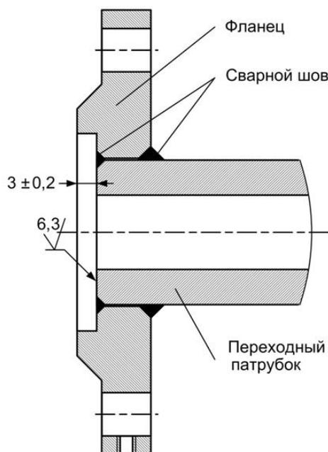
Рис.Б.4 - Вид сварки фланцев с переходным патрубком
