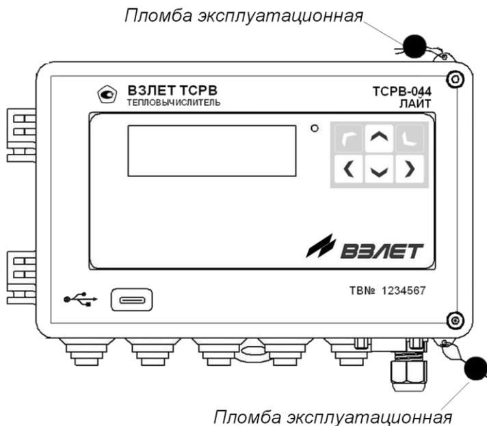
**Рис.3. Размещение маркировки и мест пломбирования корпуса ТВ.**
