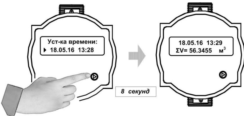
**Рис.6. Перевод расходомера в режим эксплуатации.**
