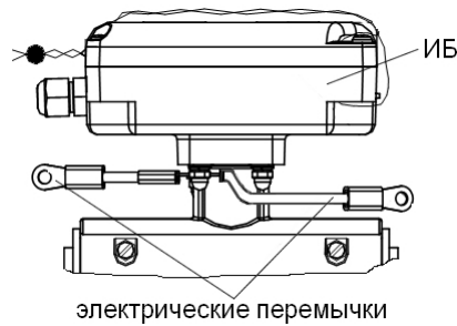
Рис.10. Электрические перемычки на ИБ расходомера.
