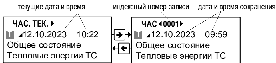
Рис.17. Обозначения параметров в окнах индикации часового архива.
