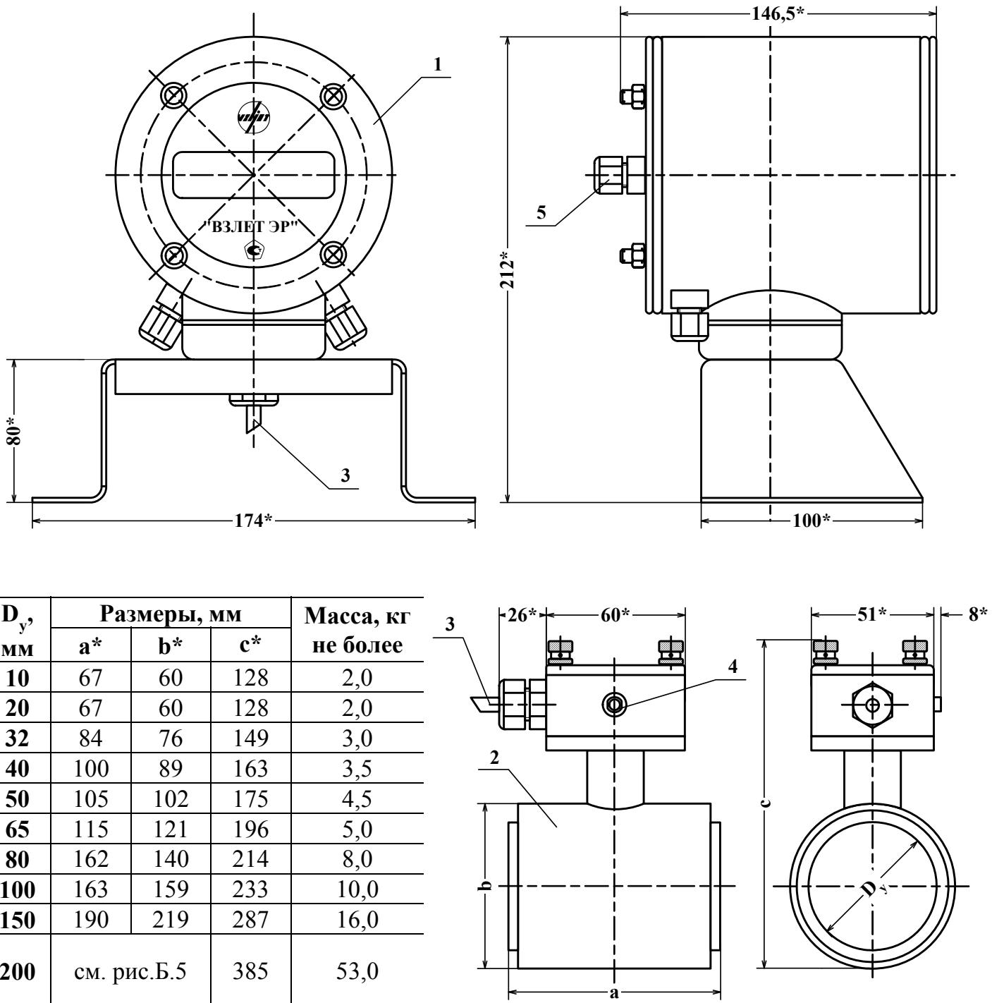
1 – измерительный блок; 2 – первичный преобразователь расхода; 3 – кабель связи ИБ-ППР; 4 – клемма электрического соединения корпуса ППР с трубопроводом; 5 – дополнительный гермоввод (при необходимости).
