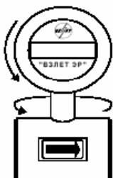
Поворот элементов расходомера (против часовой стрелки):
