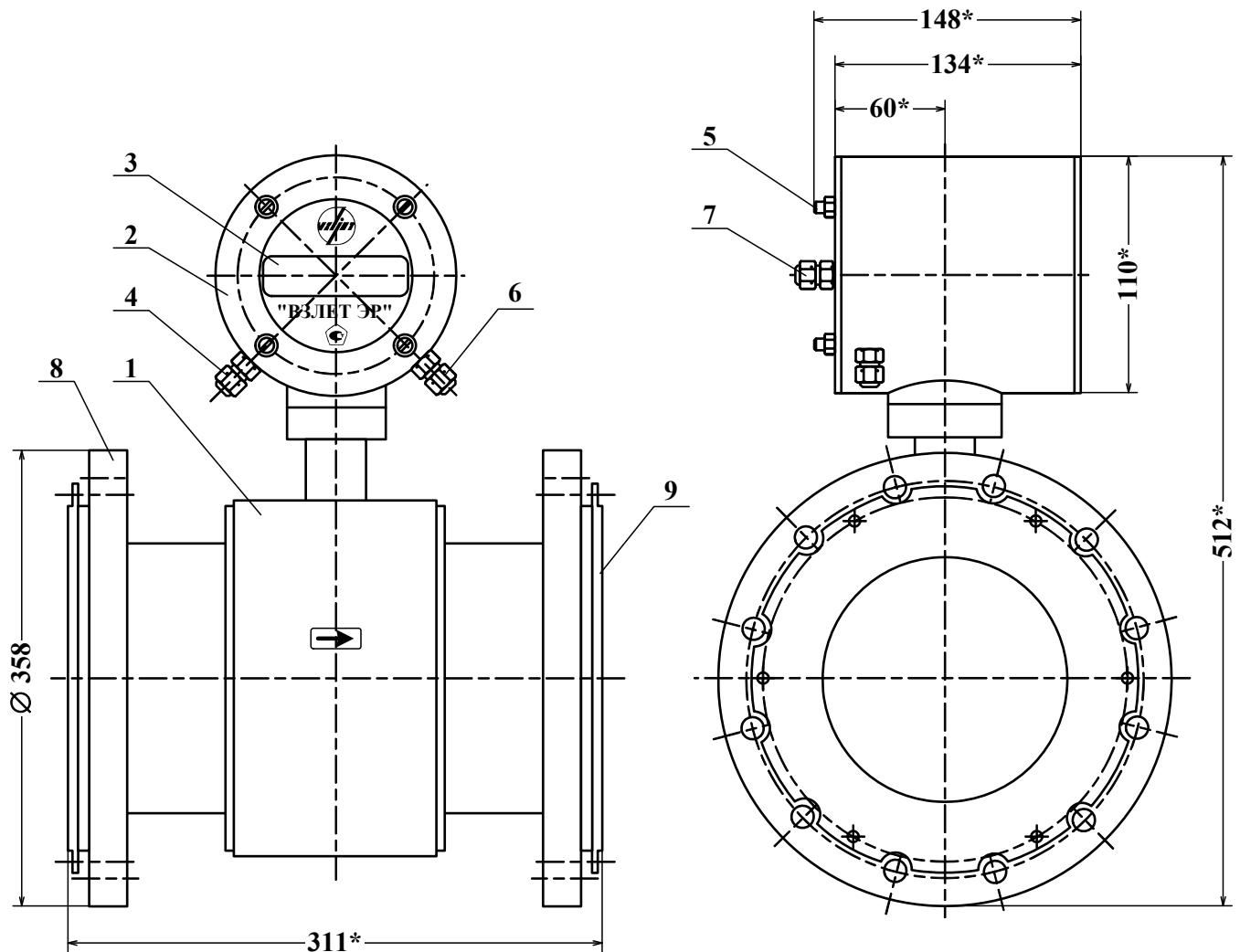
1 – первичный преобразователь расхода; 2 – измерительный блок; 3 – индикатор; 4 – гермовод кабеля связи с приемником выходного сигнала расходомера «ВЗЛЕТ ЭР»; 5 – клемма электрического соединения корпуса ЭМР с трубопроводом; 6 – гермовод кабеля питания; 7 – дополнительный гермовод (при необходимости); 8 – фланец; 9 – защитное кольцо.
