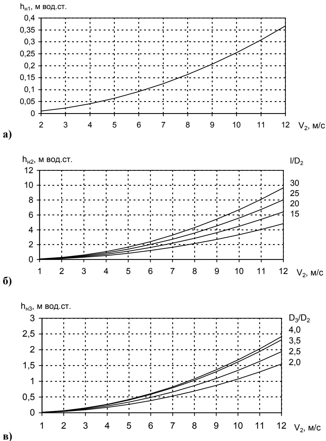
Рис. 3. Графики зависимостей потерь напора в конфузоре (а), прямолинейном участке (б) и диффузоре (в).
