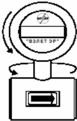
Поворот элементов расходомера (против часовой стрелки):
