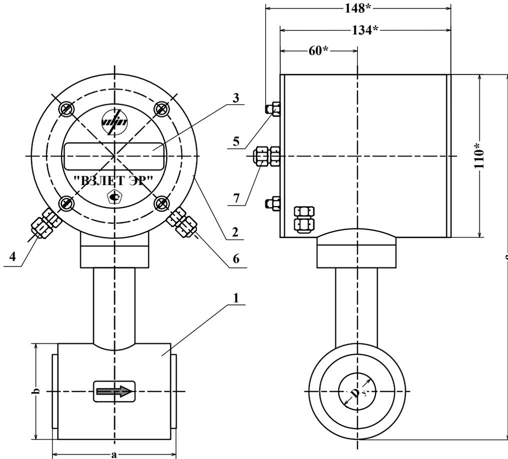
1 – первичный преобразователь расхода; 2 – измерительный блок; 3 – индикатор; 4 – гермоввод кабеля связи с приемником выходного сигнала расходомера; 5 – клемма электрического соединения корпуса ЭМР с трубопроводом; 6 – гермоввод кабеля питания; 7 – дополнительный гермоввод (при необходимости).
