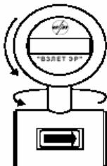
Поворот элементов расходомера (против часовой стрелки):
