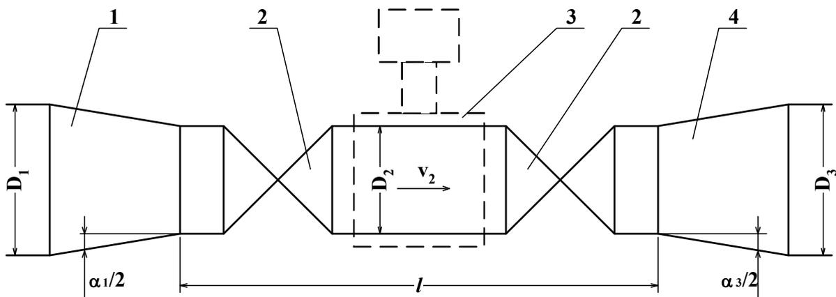
1 - конфузор; 2 - полнопроходная шаровая задвижка; 3 - ППР; 4 - диффузор.
