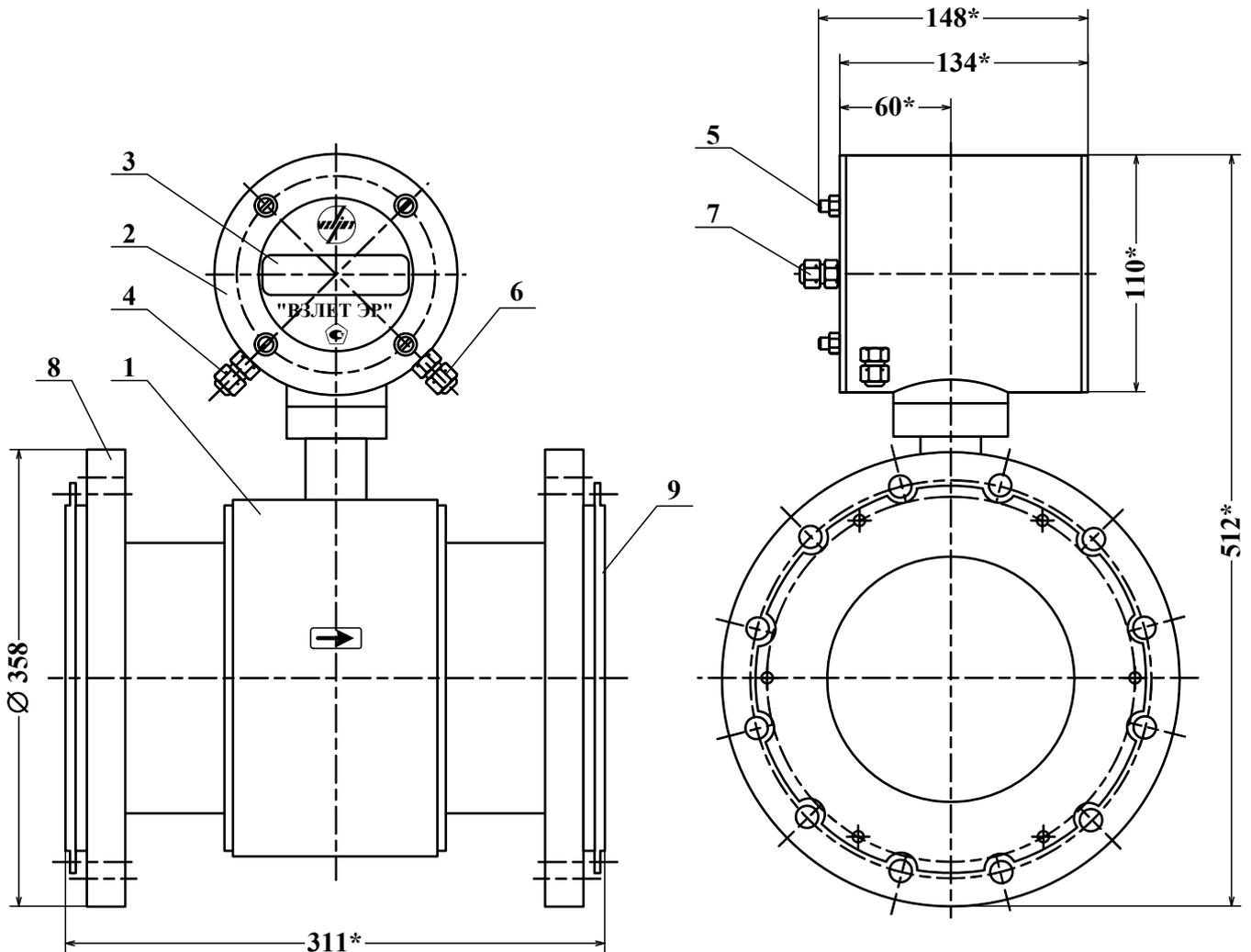
1 – первичный преобразователь расхода; 2 – измерительный блок; 3 – индикатор; 4 – гермоввод кабеля связи с приемником выходного сигнала расходомера «ВЗЛЕТ ЭР»; 5 – клемма электрического соединения корпуса ЭМР с трубопроводом; 6 – гермоввод кабеля питания; 7 – дополнительный гермоввод (при необходимости); 8 – фланец; 9 – защитное кольцо.
