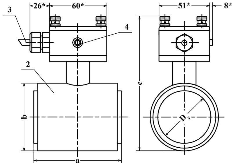
1 – измерительный блок; 2 – первичный преобразователь расхода; 3 – кабель связи ИБ-ППР; 4 – клемма электрического соединения корпуса ППР с трубопроводом; 5 – дополнительный гермоввод (при необходимости).
