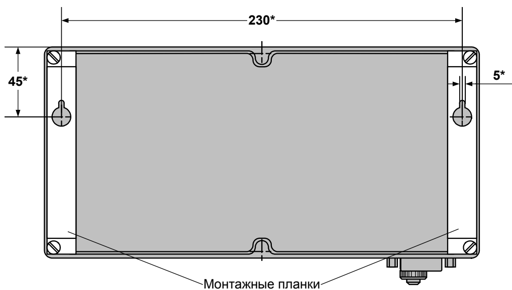
Рис. Б.5. Вид ВП с кронштейнами для крепления на DIN-рейке 35/7,5.
