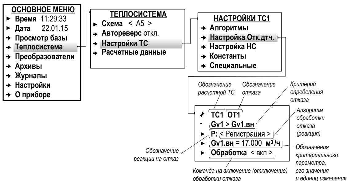
Рис.36. Вид меню настройки обработки отказов (режим СЕРВИС).
