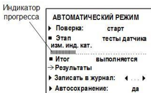
Рис.12. Отображение хода поверки на индикаторе КПИ.
