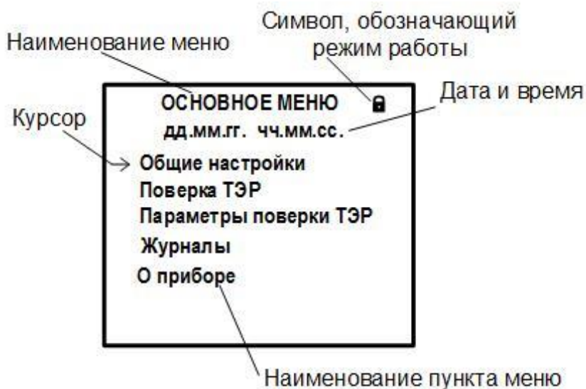
Рис.2. Вид основного меню в режиме РАБОТА.
