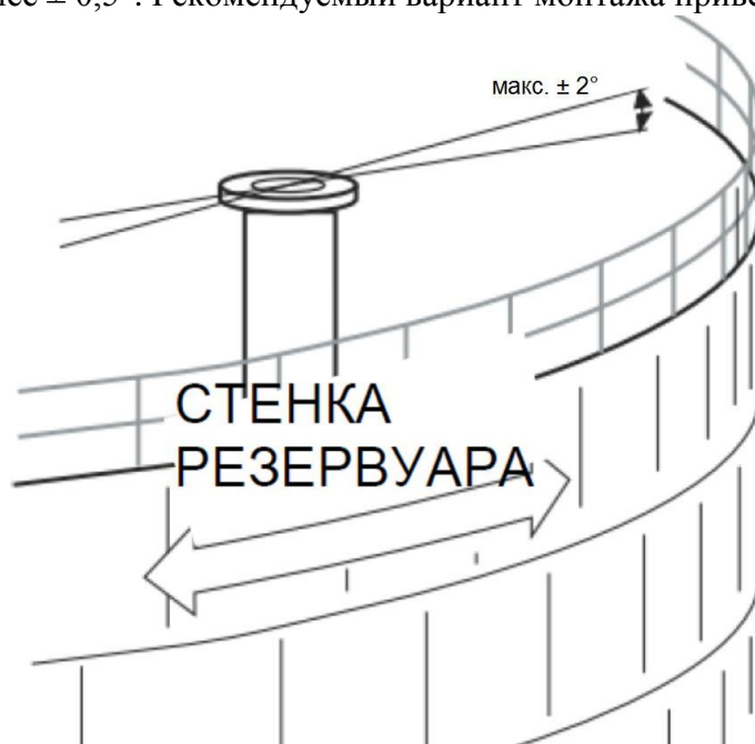
Рис.13 - Рекомендуемый вариант монтажа уровнемера на успокоительную трубу
