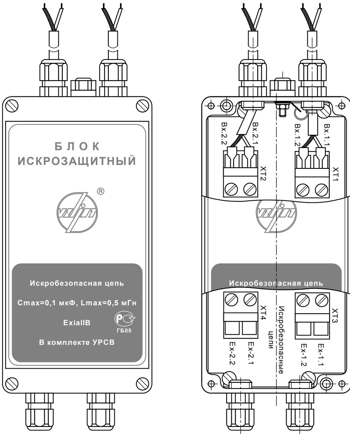
Рис. 4. Вид блока искрозащитного.
