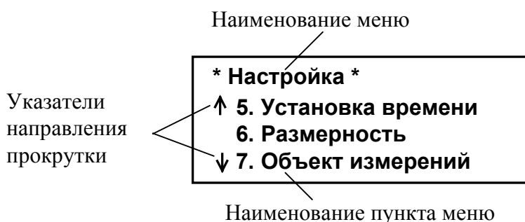
Рис. 3. Вид индикации при выборе пункта меню.
