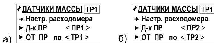
Рис.К.4. Вид окон индикации при назначении измеренного значения расхода для расчета массы в трубопроводе ТР1.
