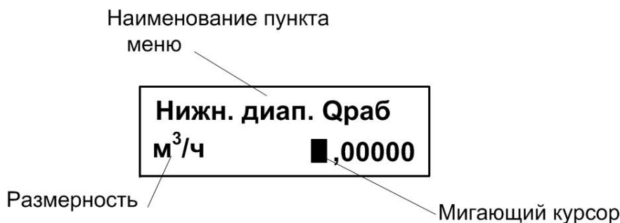
Рис.3. Пример установки нижнего диапазона измеряемого расхода в подменю Расход меню УСТ.
