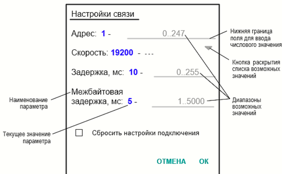
Рис.30. Вид окна редактирования значений установочных параметров.
