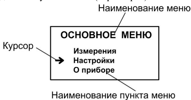
Рис.6 - Вид основного меню расходомера.
