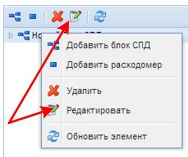
**Рис.14. Способы доступа к редактированию параметров блока СПД**
