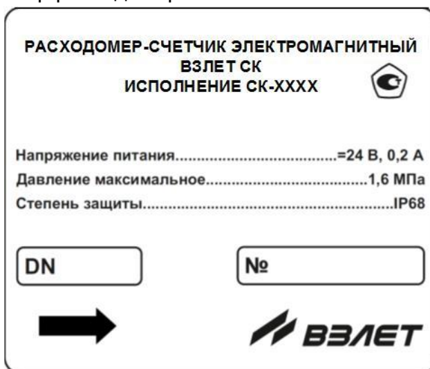
Рис.3. Гравировка на верхней части корпуса ППР расходомера.
