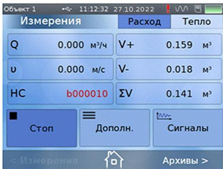
Рис.19. Отображение кода НС в окне «Измерения/Расход».
