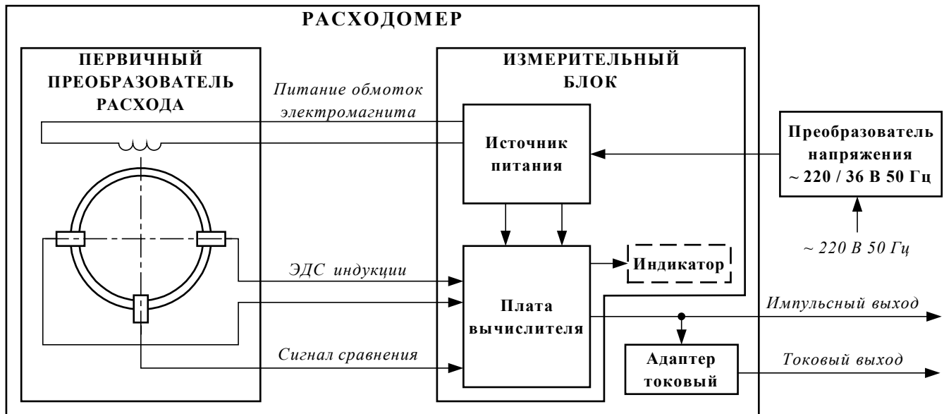
Рис. 1. Структурная схема расходомера.
