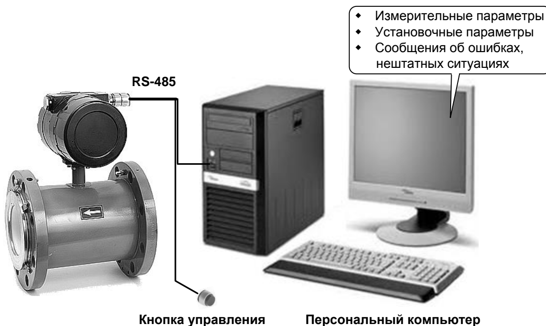
Рис.1. Средства управления расходомером ВЗЛЕТ ТЭР.
