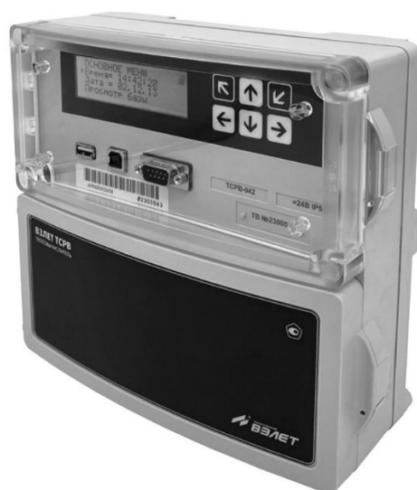
Рис.1. Тепловычислитель «ВЗЛЕТ ТСРВ» исполнения ТСРВ-042.
