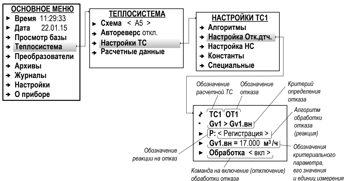
Рис.36. Вид меню настройки обработки отказов (режим СЕРВИС).
