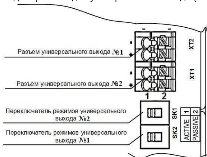
Рис.11. Универсальные выходы расходомера.
