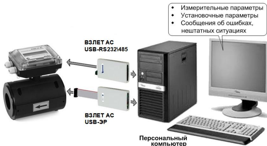
Рис.1. Средства управления расходомером «ВЗЛЕТ ЭР».
