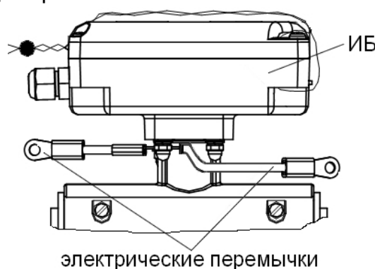
Рис.9. Электрические перемычки на ИБ расходомера.
