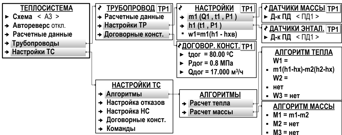
Рис.19. Вид меню настройки алгоритмов расчета тепла и массы в трубопроводах и теплосистеме (режим СЕРВИС).
