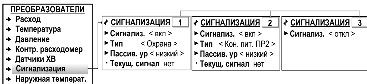
Рис.27. Вид меню настройки входов логических сигналов (режим СЕРВИС).
