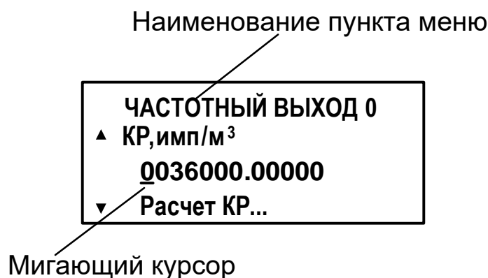
Рис.3. Пример установки константы преобразования в меню «ЧАСТОТНЫЙ ВЫХОД 0».
