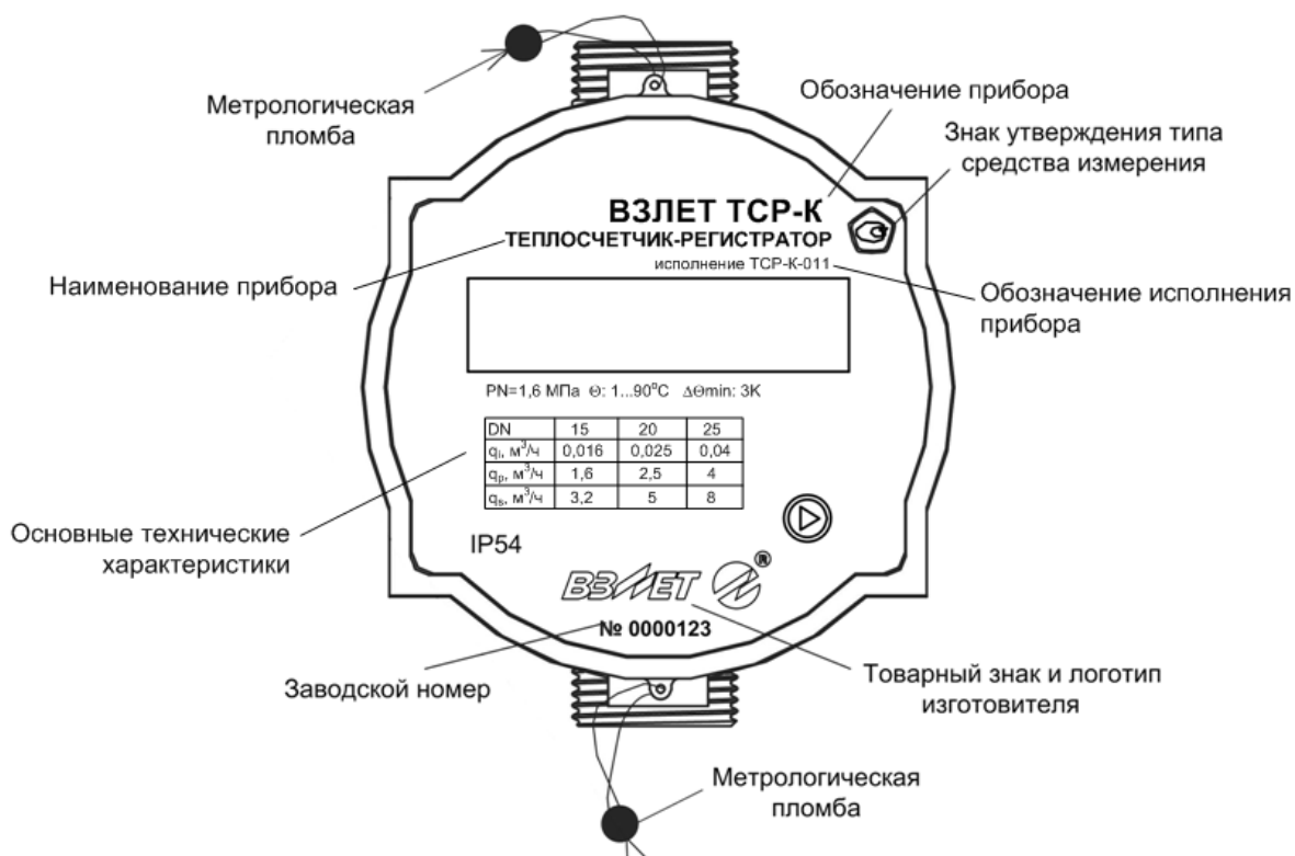
Рис.2. Вид и размещение маркировки и мест пломбирования корпуса ТСч.
