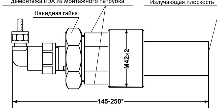
в) с титановым протектором и накидной гайкой
