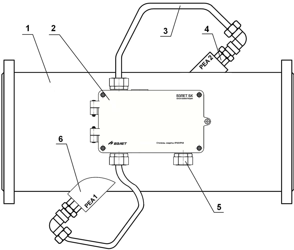
1 – измерительный участок; 2 – блок коммутации; 3 – вывод ПЭА в гибкой трубке; 4 – врезной ПЭА; 5 – ввод для кабеля связи с ВП; 6 – патрубок для установки врезного ПЭА.
